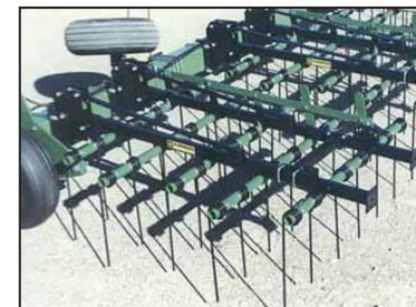
**Супер-борона Плюс** отличается от любой другой бороны. Зубья (диам. 1.4 см), изготовлены из высококачественных стальных прутьев, что обеспечивает непревзойденный результат при бороновании почвы на полях с минимальной или нулевой обработкой. **Супер-борона Плюс** может также использоваться для подготовки семяложа, рыхления, внесения гранулированных удобрений, измельчения и разбрасывания стерни и остатков после комбайна.
