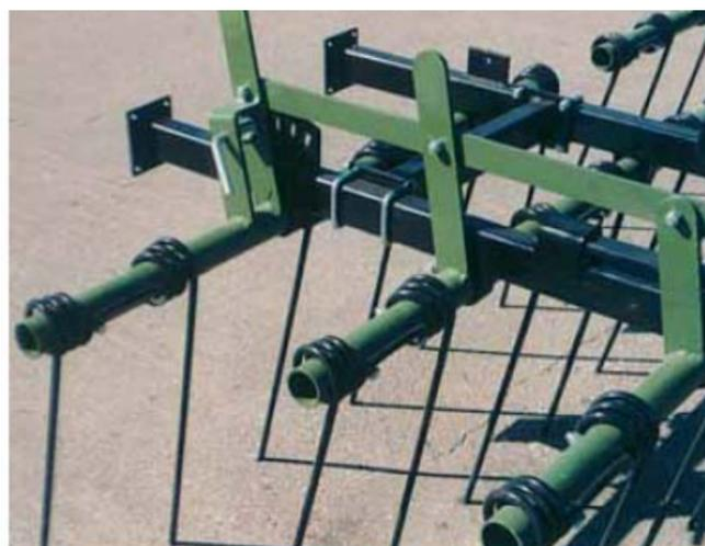
**Плюс:** Пружинные замки предусматривают легкое регулирование угла наклона зубьев: от вертикального до 45°.
