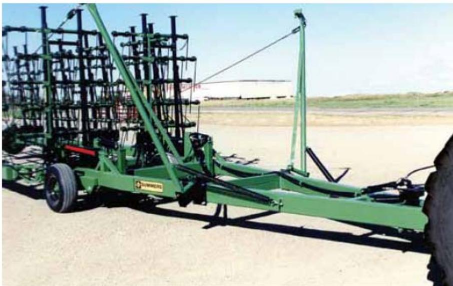
**Плюс:** Тросовая система Auto-Fold с гидравлическим управлением является стандартной для большой сцепки 22 ф (6,7 м) с тандемными мостами и с независимой подвеской. Стопорная система Auto-Fold позволяет складывать борону **на ходу**.
