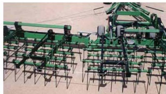
**Плюс:** Конструкция позволяет оператору включать обратный ход в развернутом (полевом) положении, чтобы обработать труднодоступные углы и для маневрирования на крутых поворотах.
