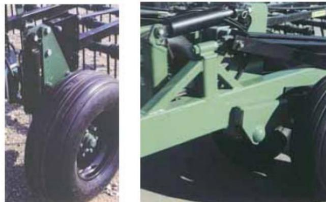
**Плюс:** Гидравлический регулятор глубины на прицепной части и колесах крыльев - стандартное оборудование. Вы можете менять заглубление и давление в зависимости от почвенных условий.
