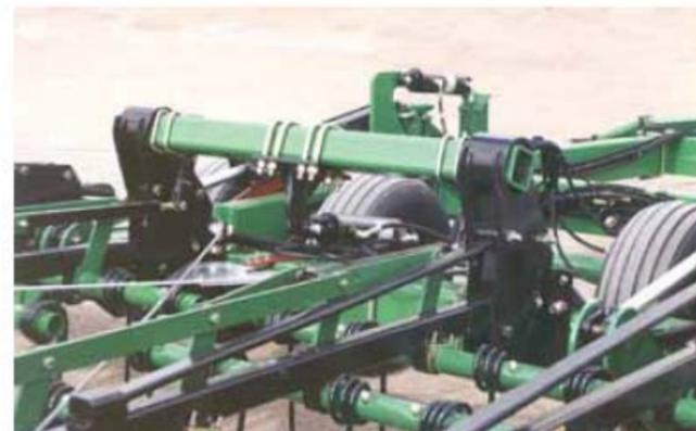
Опция: гидравлический регулятор угла наклона зубьев позволяет изменять угол наклона зубьев в соответствии с полевыми условиями или при использовании Супер-бороны **Плюс** для разных видов работ.
