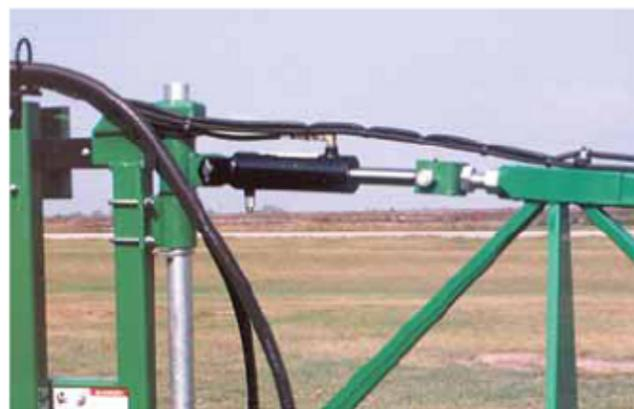
Отдельные гидравлические цилиндры для подъема крайних секций позволяют поднимать концы каждой штанги для преодоления препятствий и компенсации изгибов и неровностей рельефа.
