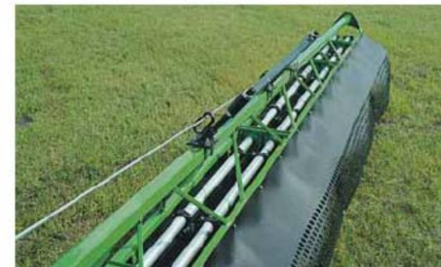
**Ultimate NT:** Гибкие ветровые щитки предлагаются как опция для машин с одиночными или двойными системами штанги (на двойные системы только до 100 футов (30,48 м)). Щитки защищают от сноса. Модель **Ultra Ultimate NT** не предусматривает наличие ветровых щитов.
