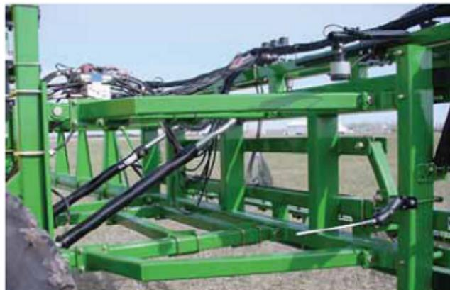
Параллельное соединение обеспечивает прочность при подъеме штанг и постоянный угол атаки распыляющих форсунок независимо от рельефа поля.
