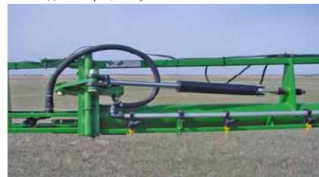
Обе модели: Ultra и Ultimate NT – имеют запатентованную многофункциональную систему сгибания и отклонения штанг, наряду с защитой от повреждений, вмонтированную в гидравлическую систему. Азотный аккумулятор помогает штангам мягко вернуться в полевую позицию после преодоления препятствия.
