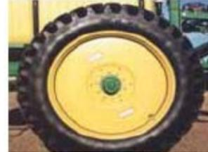
Колеса с шинами 480/80R38 с узким межкостным расстоянием могут быть отрегулированы на ширину от 203 до 305 см (80 - 120 дюймов). Шины 380/90R46 (опция см. справа) позволяют регулировать ширину от 193 до 305 см (76 - 120 дюймов).
