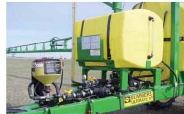
Конструкция опрыскивателя состоит из материалов, устойчивых к коррозии, включает электрические шаровые клапаны для левой, правой и центральной секций штанги. В стандартную комплектацию входят: смеситель, сетки, вход для заполнения снизу диам. 5 см (2 ") и система слива. Регулятор потока смесителя и внутренние сетки-фильтры завершают систему. Стандартный полимерный резервуар - объемом 3785 л (1000 гал), как опцию предлагаем резервуар - 5678 л (1500 галл). Оба резервуара имеют систему слива.
