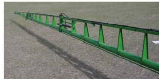
Опрыскиватели **Ultra Ultimate NT** имеют рабочую ширину 120 футов (36,58 м) и 133 фута 4 дюйма (40,66 м), Расстояние между форсунками 20 дюймов (50,8 см).
