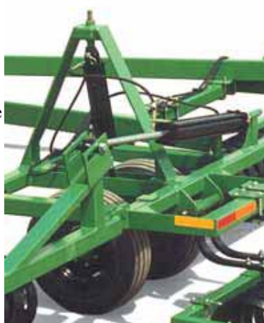
Размер прикатывающих спиралей 1-3/4", вес 150 ф.на фут.
