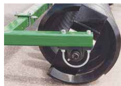
Размер прикатывающих спиралей 1-3/4", вес 150 ф.на фут.
